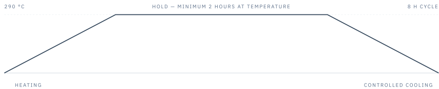
FIG. 03 — EN 14179 HEAT SOAK CYCLE
