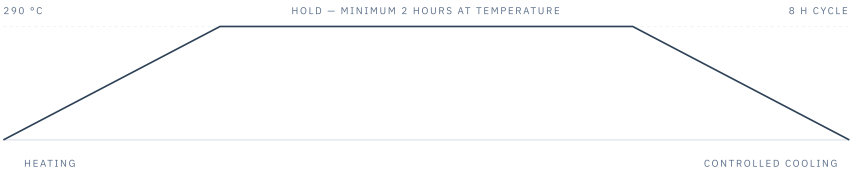
FIG. 03 — EN 14179 HEAT SOAK CYCLE
